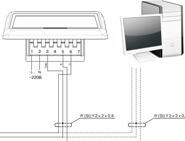
**⚠** Для перевода базовой платы конвектора в режим управления через интерфейс RS-485, необходимо установить положение микропереключателей J1-ON, J2-ON. Для согласования линии RS-485 с нагрузкой используйте микропереключатели J4 и J5. J3 увеличивает постоянную составляющую, J4 уменьшает постоянную составляющую.
