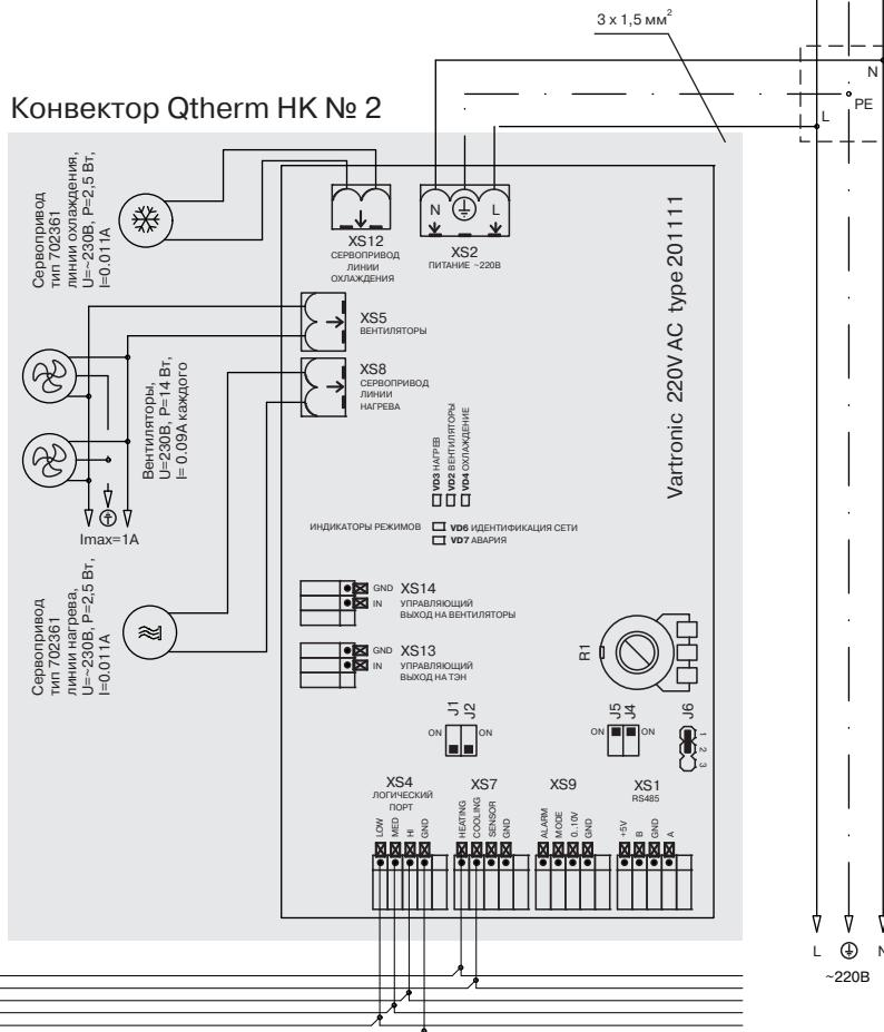
**!** Для перевода базовой платы конвектора в режим управления через логический вход, необходимо установить положение микропереключателей J1-OFF, J2-OFF
