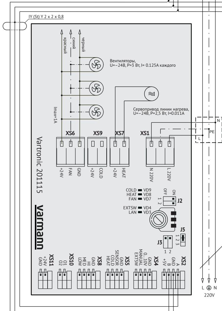
Настенный регулятор Vartronic 703201, 703202 осуществляет регулирование температуры в помещении посредством плавного изменения скорости вращения вентиляторов и управлением термоэлектрическим сервоприводом для изменения расхода теплоносителя через теплообменник конвектора.
