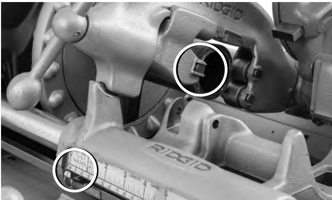
Figure 20A – Lame du galet de coupe appuyée contre l'extrémité du tuyau. Curseur à « 0 ».
