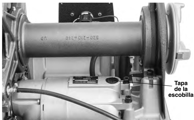
Figura 34 – Extracción de la tapa del motor para cambiar las escobillas
