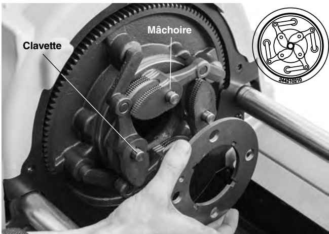
Figure 32 – Remplacement des mâchoires sur machines à mandrin automatique
