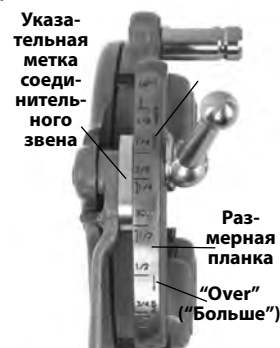
Рис. 6 – Настройка размера резьбы
