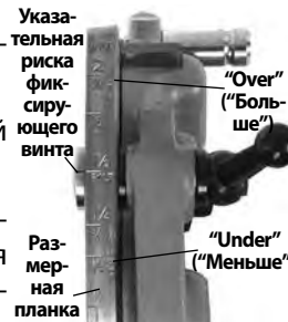
Рис. 10 – Настройка размера резьбы
