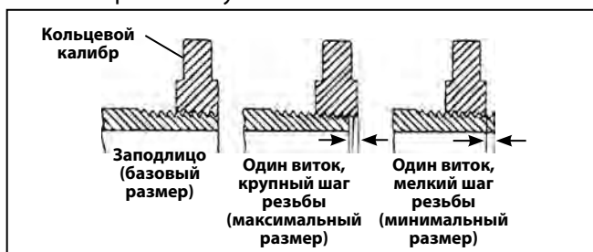
Рис. 25 – Проверка размера резьбы
