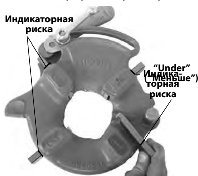
Рис. 5 – Вставка резьбонарезных гребенок
