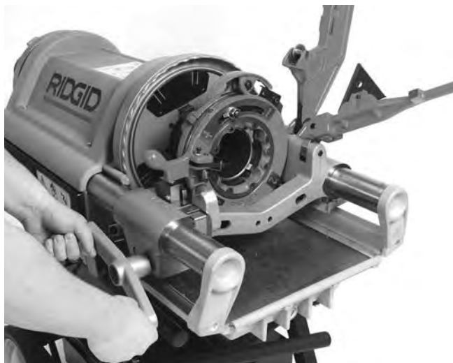
Рис. 23 – Нарезание резьбы на трубе (показана резьбонарезная головка 714)
