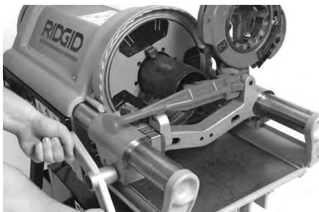
Рис. 22 – Зенкование трубы с использованием зенковки
