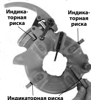
Рис. 9 – Вставка резьбонарезных гребенок
