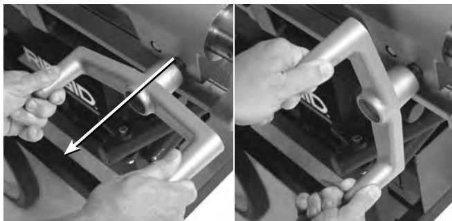
Рис. 20 – Регулировка положения ручного маховичка каретки
