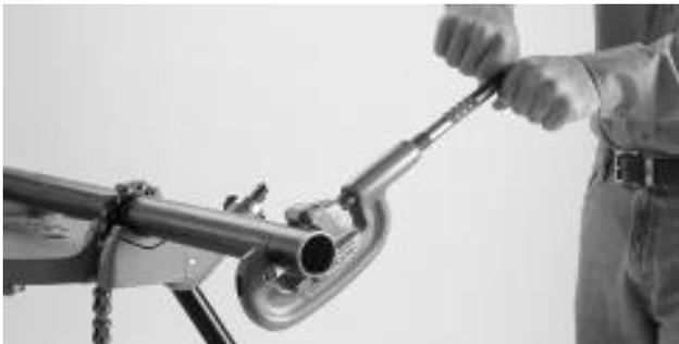
**Рис. 1 – Резка края трубы**
