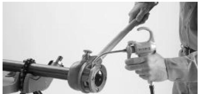
**Рис. 4 – Нанесение резьбонарезного масла на трубу**
