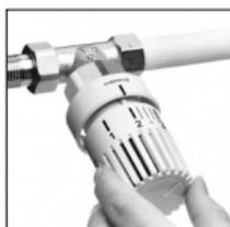
Bild 9: Handgriff unter gleichzeitigem, leichten Andrücken auf die Merzkahl „2“ verdrehen. Den Handgriff wieder abnehmen. (Die Justiermarkierung auf dem Fühlerhalter ist nun nach rechts verdreht.)
