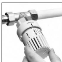
Bild 11: Der Handgriff wird jetzt so aufgesteckt, dass die Merzkahl „2“ gegenüber der Einstellmarke liegt. Die Einstellung ist nun in der Position „2“ (ca. 16 °C) blockiert. Dann mit dem Handballen kräftig gegen den Handgriff drücken oder gegenschieben, bis er einrastet.
