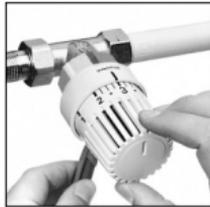
Bild 12: Zum Abziehen des Handrades ist das Werkzeug (Art.-Nr. 1989100) oder ein passender Stift, z. B. der Druckknopf eines Kugelschreibers in das Demontageloch auf der Unterseite des Thermostaten zu stecken. Durch Drehen des Handgriffes nach rechts bis in die Schließstellung kann dieser leicht gelöst werden.
