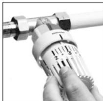
Bild 8: Der Handgriff wird jetzt **lose** aufgesteckt, so dass die Merzkahl „3“ gegenüber der Einstellmarke liegt.
