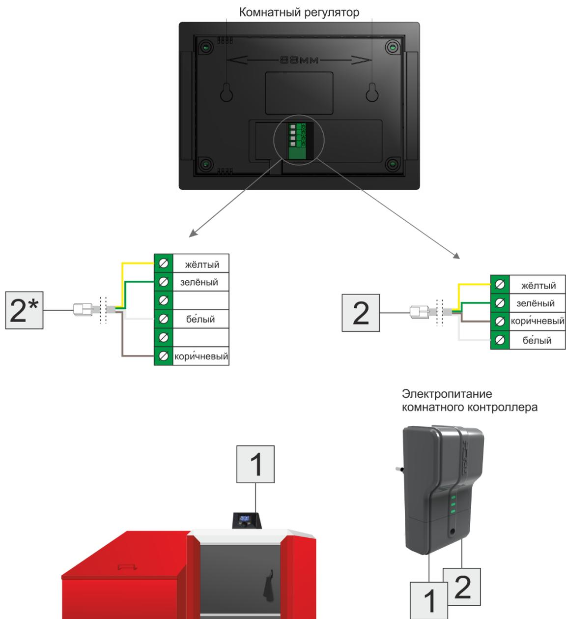
Четырехжильный кабель необходимо подключить к соединению регулятора в соответствии со схемой подключения проводов. Кабель закончен вилкой RJ12, которую нужно подключить в питатель регулятора — место соединения обозначенное на схеме номером 2 (дополнительное описание находится на источнике питания). Источник питания регулятора соединяется с контроллером котла тоже при помощи четырехжильного кабеля по обоим сторонам законченного вилками RJ12 — на схеме соединения обозначены номерами 1.
