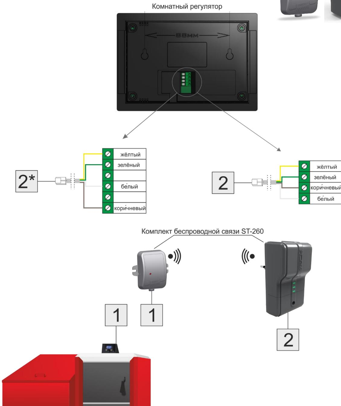
регулятора в соответствии со схемой подключения проводов. Этот кабель закончен вилкой RJ12, которая должны быть подключена к модулю v2 — место соединения обозначено на схеме номером 2 (дополнительное описание находится на модуле). Контролер котла соединяется с модулем v1 тоже при помощи четырехжильного кабеля законченного вилкой RJ12 — на схеме соединения обозначены номерами 1.
