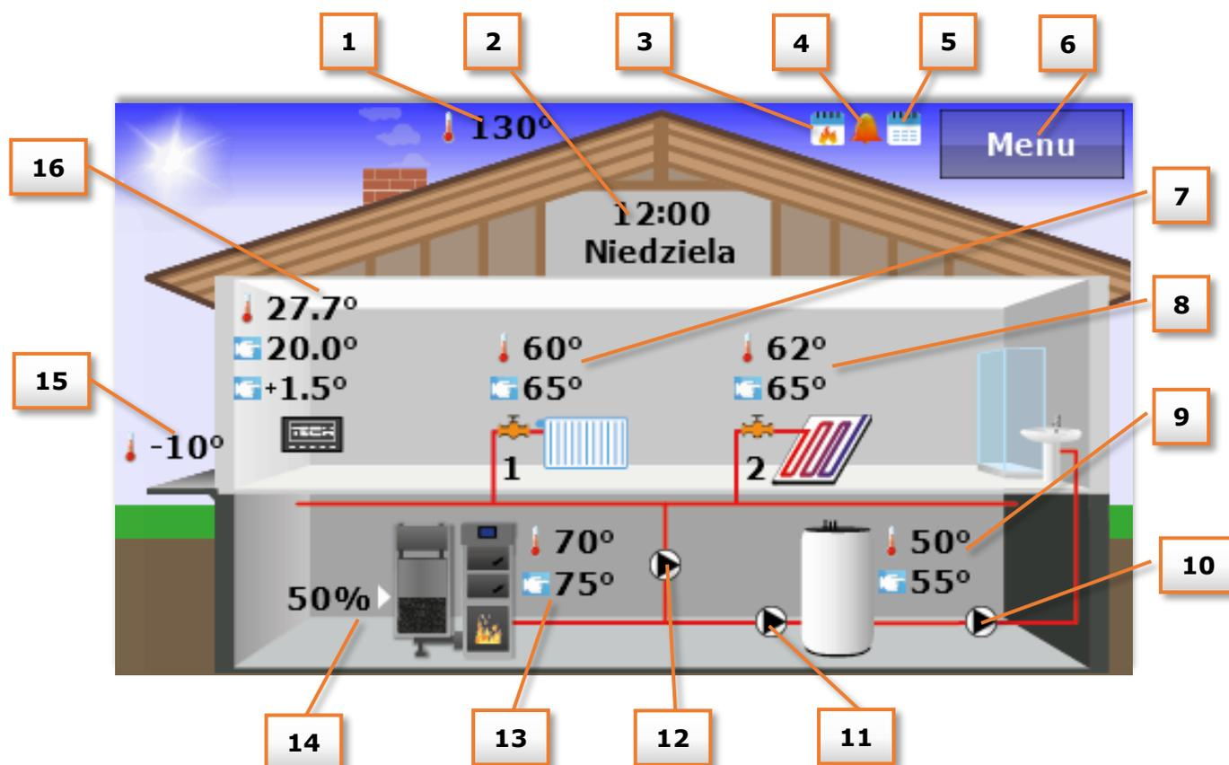
1. Температура выхлопных газов (только в случае применения датчика выхлопных газов в главном контроллере)
