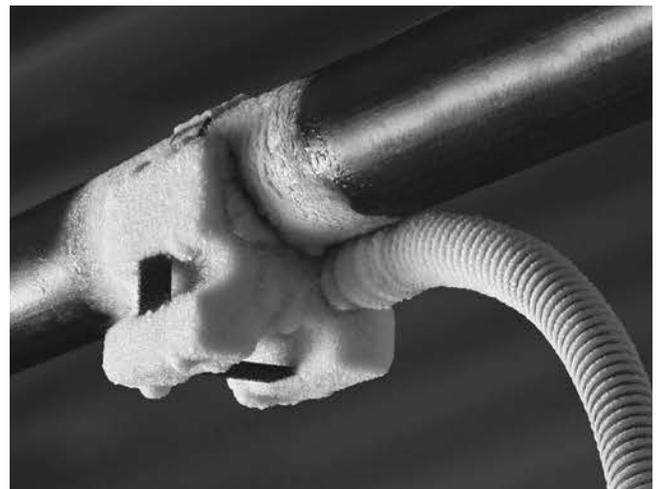
**Рис. 9 – Примерзшая к трубе замораживающая головка**
