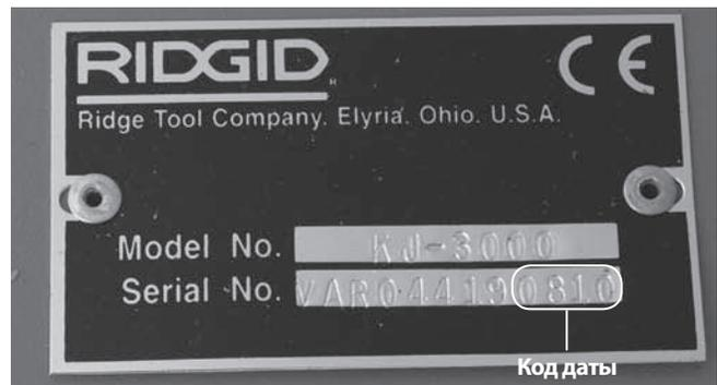
Рис. 3 – Заводской номер установки
