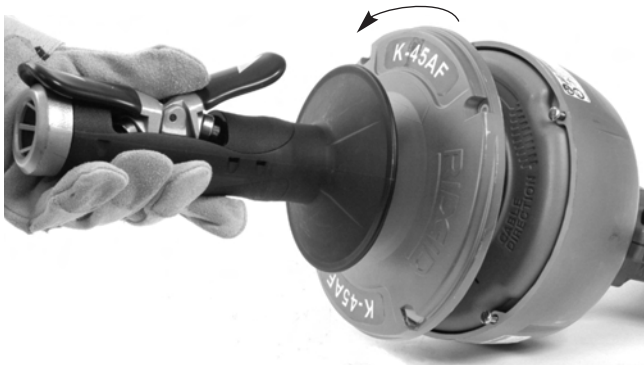
Рис. 14 – Проверните и отделите крышки барабана
