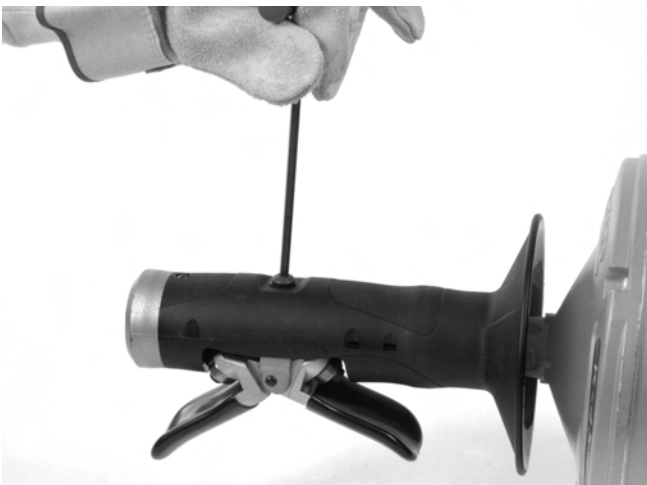
Рис. 12A – Отворачивание винта автоподачи AUTOFEED
