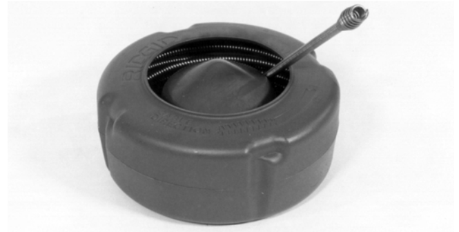
Рис. 16 – При загрузке троса во внутренний барабан трос необходимо наматывать ПО ЧАСОВОЙ СТРЕЛКЕ
