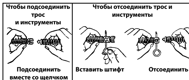
Рис. 1: Соединение и разъединение тросов и инструментов
