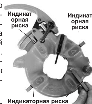
Рис. 12 – Вставка резьбонарезных гребенок
