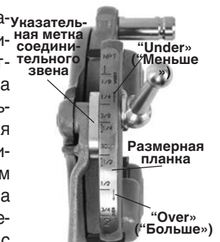
Рис. 9 – Настройка размера резьбы
