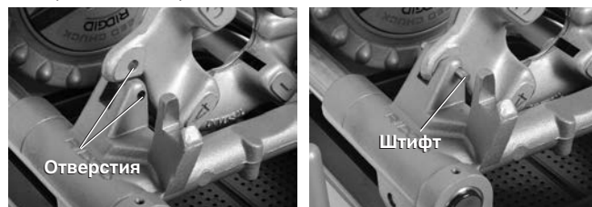
Рис. 26 – Фиксация левой резьбонарезной головки на месте
