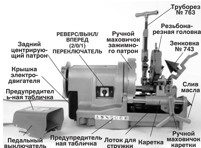
Рис. 2 – Резьбонарезной станок модели 1233
