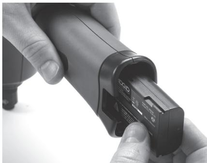
Рис. 6 - Извлечение/установка батареи
