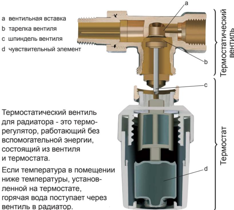
Термостатический вентиль для радиатора - это термо-регулятор, работающий без вспомогательной энергии, состоящий из вентиля и термостата.
