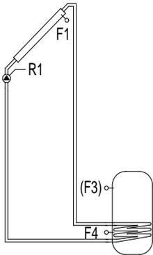
Солнечный контроллер сравнивает температуру коллектора F1 (Tc) с температурой в нижней части ёмкости F4. Если измеренная разница температур превышает разницу температур включения TDE, то включается насос R1 (управляется скорость вращения)
