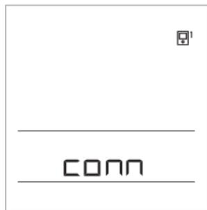
Durante il primo funzionamento, l'indirizzo dell'unità si imposta automaticamente. Se é connessa una sola unità, acquisisce l'indirizzo 1. Se é connessa un'unità supplementare, questa acquisisce l'indirizzo 2. Se si collegano contemporaneamente due unità, l'indirizzo deve essere confermato o impostato su una di esse, e l'altra unità acquisirà automaticamente il rimanente. Per impostazioni di fabbrica, l'unità 1 é assegnata al circuito di riscaldamento primario e l'unità 2 al secondario.
