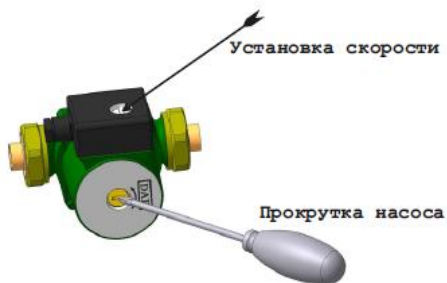
Рис. 23 Схема обслуживания насоса.
