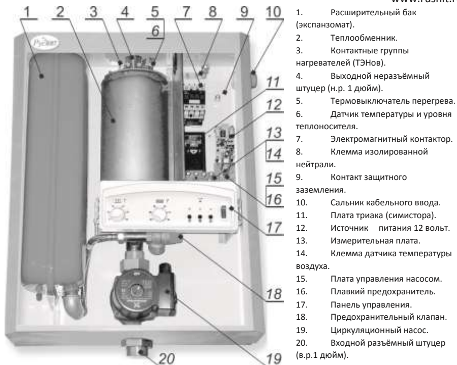
Рис.1. Состав отопителя.
