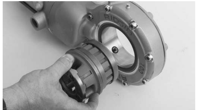
Рис. 4 – Установка резьбонарезных головок в силовой привод модели 700
