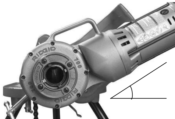
Рис. 6 – Струбцина-фиксатор с силовым приводом 700, который расположен немного выше горизонтали
