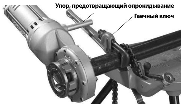
Рис. 7 – Нарезание резьбы с использованием трубного ключа в качестве струбцины-фиксатора
