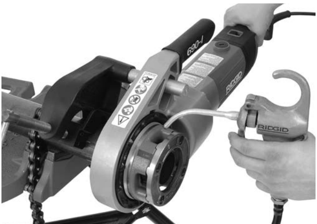
Figura 14 – Roscado de un tubo
