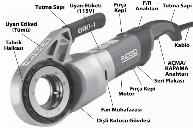
Şekil 2 - 690-I Model Elektrikli El Paftası
