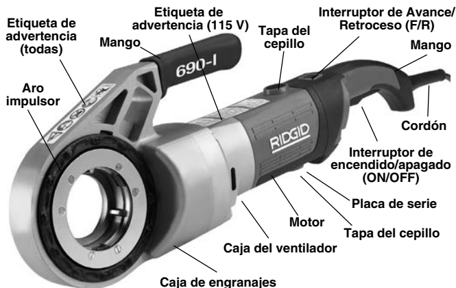
Figura 2 – Accionamiento motorizado Modelo 690-I
