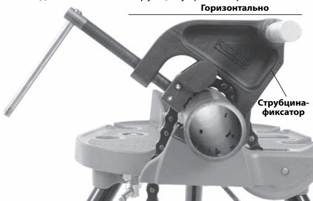
Рис. 11А – Расположение струбцины-фиксатора
