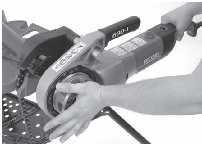
Рис. 13 – Начало нарезания резьбы
