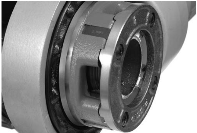
Figure 15 – Tuyau arrivé à fleur des filières
