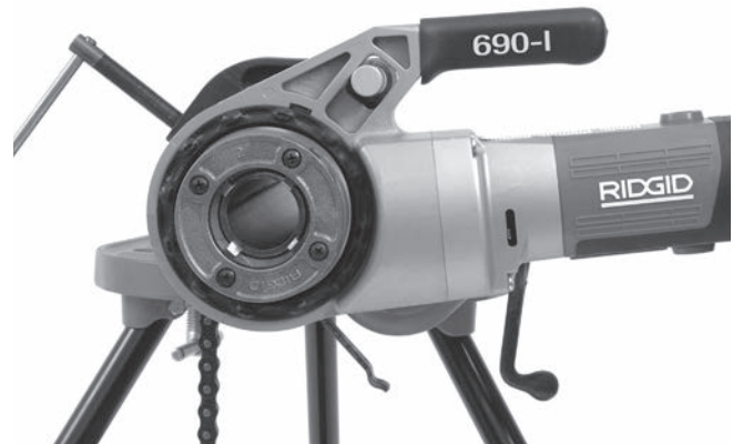
Şekil 12 - Elektrikli El Paftasının Doğru Yönü
