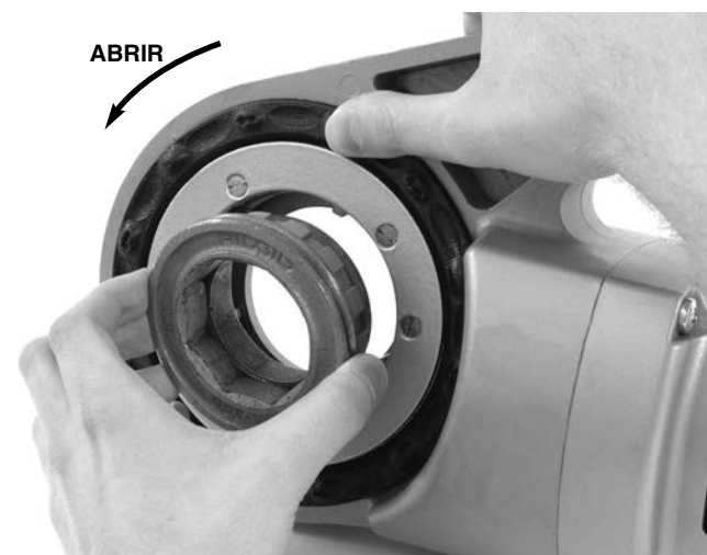
Figura 8 – Montaje del adaptador en la máquina 690-I
