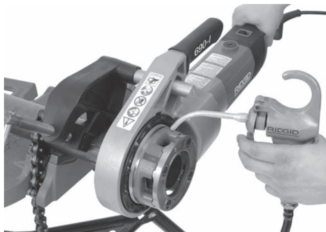
Рис. 14 – Нарезание резьбы на трубе
