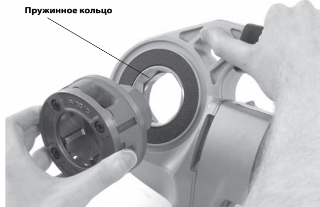
Рис. 9 – Установка резьбонарезных головок в силовой привод 600-I
