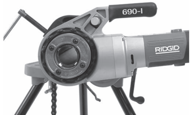
Рис. 12 – Правильное расположение силового привода
