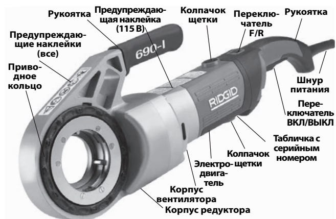
Рис. 2 – Силовой привод модели 690-I
