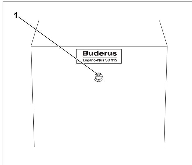
Рис. 3 Кнопка подавления помех со встроенной сигнальной лампочкой
