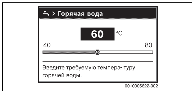
Рис. 9 Установка максимальной температуры горячей воды
