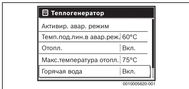
Рис. 8 Включение приготовления горячей воды
