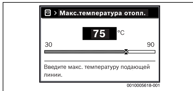
Рис. 7 Установка максимальной температуры подающей линии
