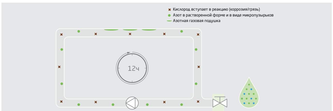
Рис.78. В системе отопления кислород быстро вступает в реакцию
