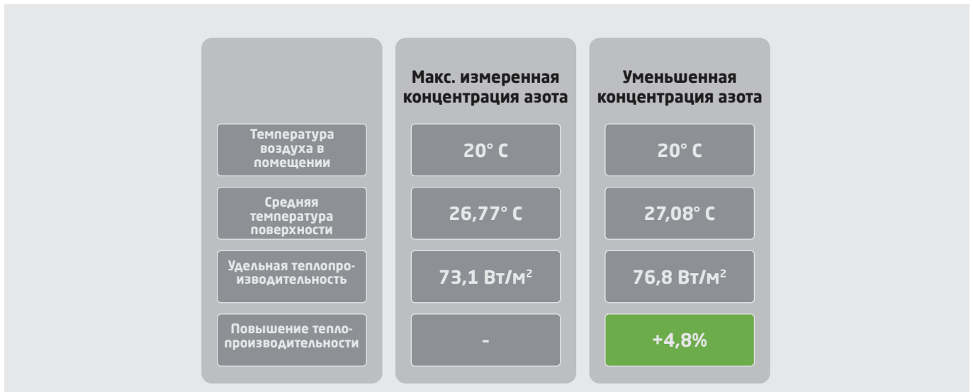
Рис. 160: Сравнение температуры поверхности и удельной теплопроизводительности
