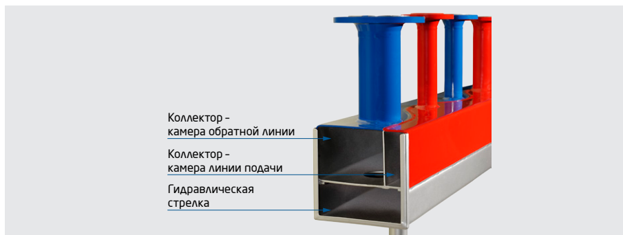
Рис. 23. Устройство блока HydroFixx
