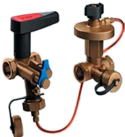
В качестве клапан-партнера может быть использован клапан Ballorex Vario с функцией дренажа. Импульсная трубка Ballorex Delta подключается к дренажному крану клапана Ballorex Vario, установленного на подающем трубопроводе.
