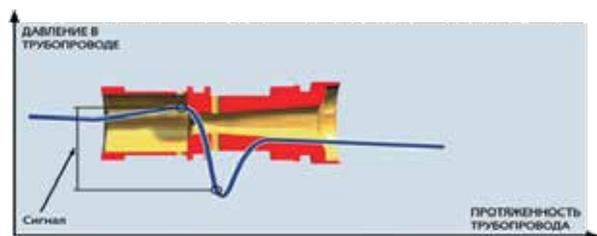
Другая отличительная особенность клапана Vallorex Venturi заключается в применении измерительной диафрагмы на основе сопла Venturi, позволяющей создать большой перепад давления между портами высокого и низкого давления и обеспечить точность измерений с погрешностью, не превышающей 3%, даже на малых расходах.
