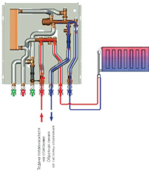
**Рис.2 Режим отопления**
