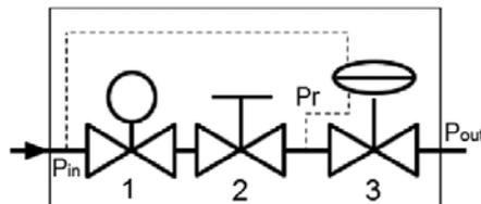
Известно, что расход среды  $Q$  (м<sup>3</sup>/ч) через клапан определяется в зависимости от величин его пропускной способности  $K_v$  (м<sup>3</sup>/ч) и перепада давления  $\Delta P$  (бар) следующим соотношением:
