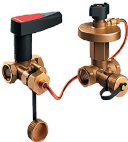
В качестве клапана-партнера может быть использован клапан Vallorex Basic. Импульсная трубка Vallorex Delta подключается к дренажному крану клапана Vallorex Basic, установленного на подающем трубопроводе.
