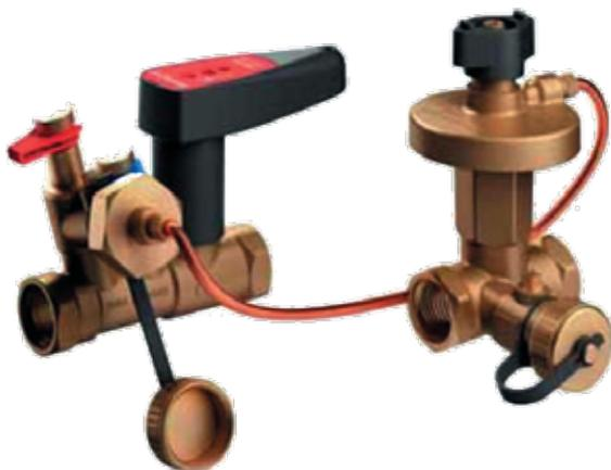
В качестве клапана-партнера может быть использован клапан Ballorex Venturi с функцией дренажа. Импульсная трубка Ballorex Delta подключается к дренажному крану клапана Ballorex Venturi, установленного на подающем трубопроводе.
