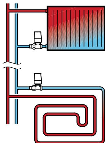
Для регулирования температуры теплоносителя в обратной линии
