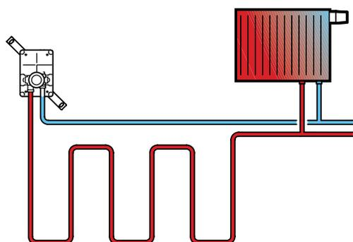
Регулировочные короба предназначены для регулирования температуры напольного и настенного отопления в помещении площадью 10-12 м<sup>2</sup>. Регулировка осуществляется по температуре обратного потока или температуре в помещении.
