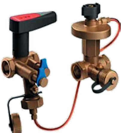
В качестве клапана-партнера может быть использован клапан Ballorex Vario с функцией дренажа. Импульсная трубка Ballorex Delta подключается к дренажному крану клапана Ballorex Vario, установленного на подающем трубопроводе.
