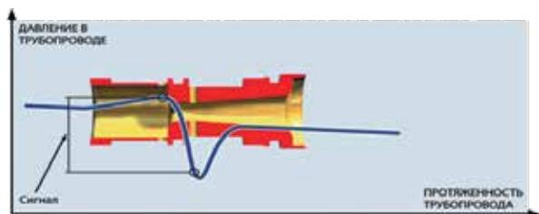
Другая отличительная особенность клапана Ballorex Venturi заключается в применении измерительной диафрагмы на основе сопла Venturi, позволяющей создать большой перепад давления между портами высокого и низкого давления и обеспечить точность измерений с погрешностью, не превышающей 3%, даже на малых расходах.
