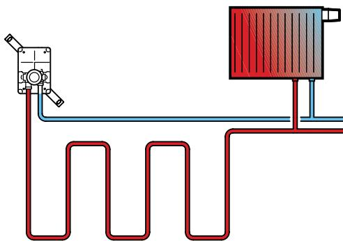
Регулировочные короба предназначены для регулирования температуры напольного и настенного отопления в помещении площадью 10-12 м<sup>2</sup>. Регулировка осуществляется по температуре обратного потока или температуре в помещении.
