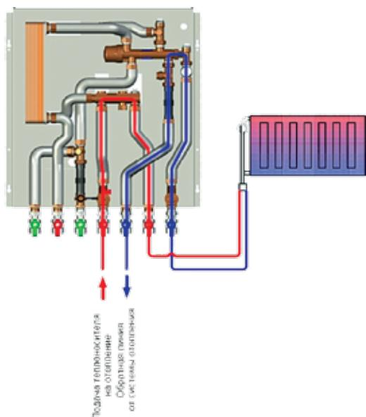
**Рис.2 Режим отопления**
