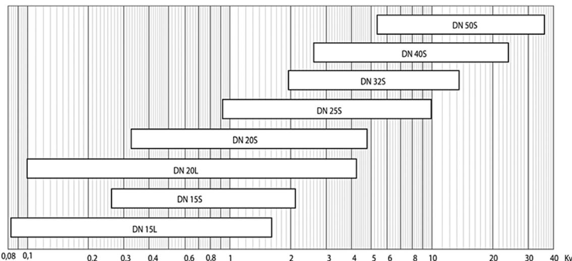
Таблица Kv клапана Ballorex Venturi DRV
