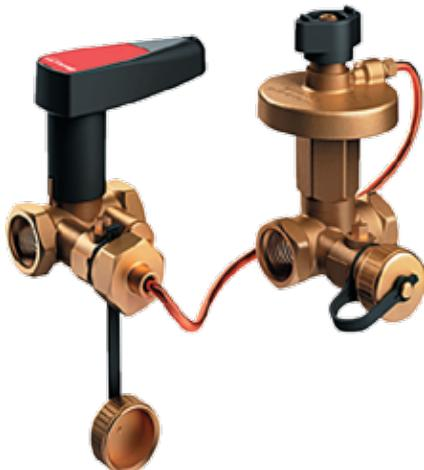
В качестве клапана-партнера может быть использован клапан Ballorex Basic. Импульсная трубка Ballorex Delta подключается к дренажному крану клапана Ballorex Basic, установленного на подающем трубопроводе.
