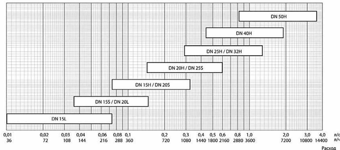
Таблица Kv клапана Ballorex Venturi FODRV
