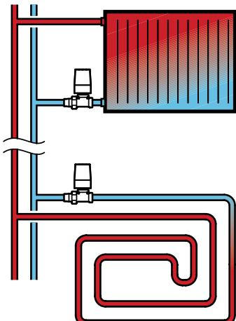
Для регулирования температуры теплоносителя в обратной линии
