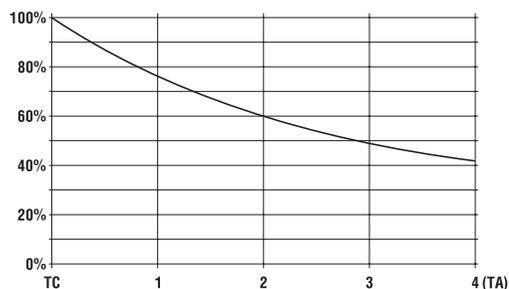
Коэффициент затекания теплоносителя в радиатор в зависимости от числа оборотов открытия байпаса.
