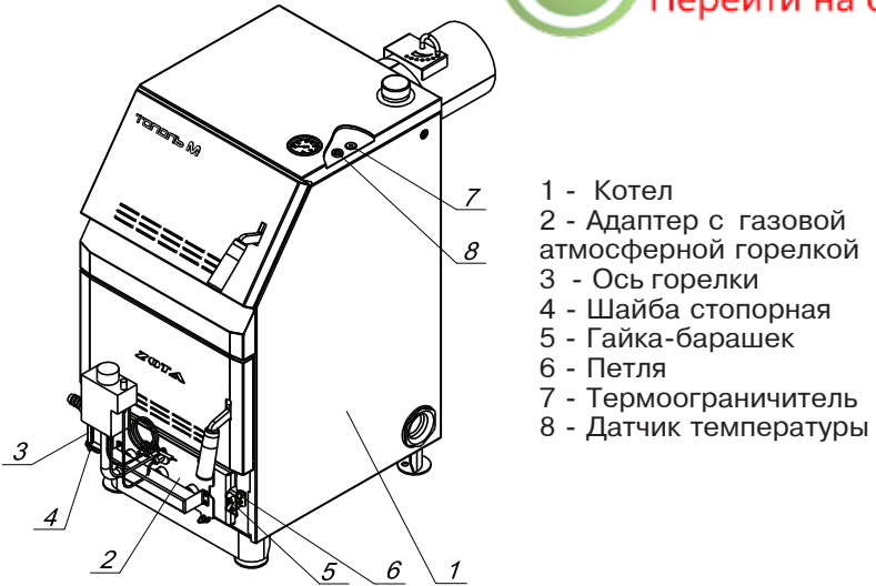
Рис.2 Установка газовой горелки на отопительный котел
