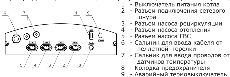
Рис.6 Расположение органов управления на задней панели пульта
