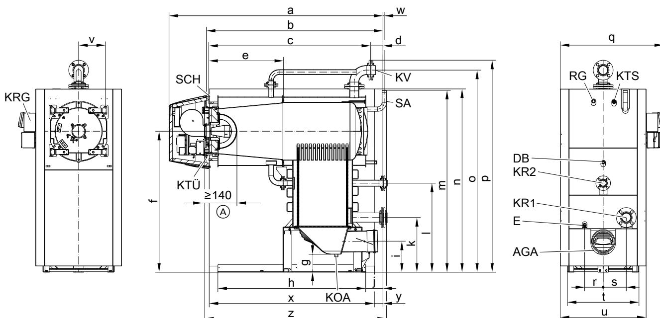
(A) Для обеспечения исправной работы соблюдать требуемую минимальную длину жаровой трубы горелки.
