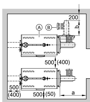
Для обеспечения простого монтажа и техобслуживания необходимо соблюдение указанных размеров; при ограниченном пространстве для монтажа достаточно выдержать минимальные расстояния (указанные в скобках). В состоянии при поставке дверца котла установлена с поворотом вправо. Шарнирные болты могут быть переставлены таким образом, чтобы дверца котла открывалась влево.
