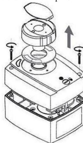
Отвернув два винта крепления, снимите рукоятку вала и крышку корпуса.
