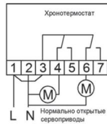
Клеммы 6 и 7 подключаются к сервоприводам системы встроенного обогрева (значок теплого пола на корпусе). Клеммы 4 и 5 подключаются к сервоприводам радиаторного отопления (значок радиатора на корпусе).
