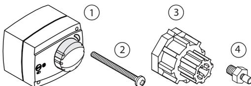
4.1. Снимите с трёхходового смесительного клапана (а) рукоятку, установите адаптер (b) и фиксирующую шпильку (с).
