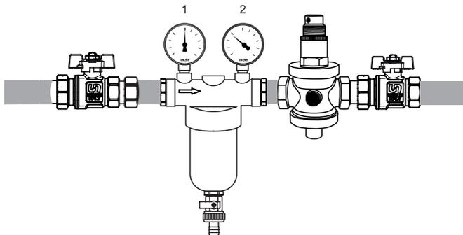
Для оптимального режима работы фильтра важно проводить регулярную очистку с частотой (мин. 1 раз в 6 месяцев), чтобы удалить частицы, оседающие в корпусе.
