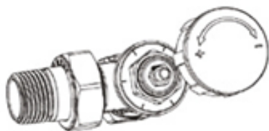
Снять защитный колпачок или термоголовку
