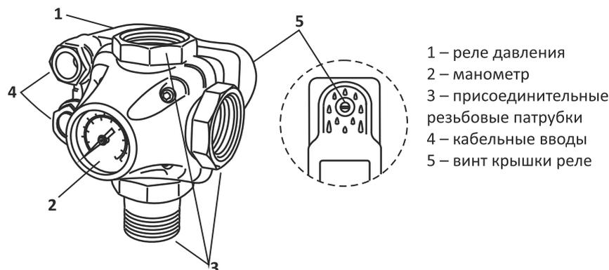
Устройство представляет собой двухконтактное реле коммутации электрических цепей, срабатывающее по давлению воды. Когда давление в системе меньше предварительно настроенной величины  $R_{\text{мин}}$ , контакты реле замкнуты. Когда давление в системе достигнет заданного верхнего порога  $R_{\text{макс}}$ , его контакты размыкаются, и насос автоматически отключается.
