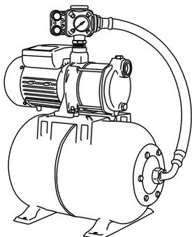
Открутив пластиковый винт (5), снимите крышку реле давления и произведите подключение устройства к электрической сети трехжильным кабелем, сечением 1,5 мм<sup>2</sup>, согласно приведенной схеме.
