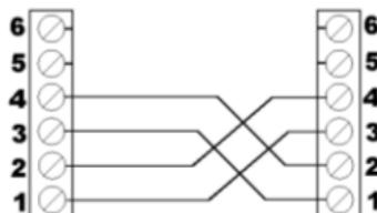
**СОЕДИНЕНИЕ:** Соединение между двумя устройствами может быть выполнено при помощи экранированного кабеля 4х0,5 мм<sup>2</sup>, как показано на схеме рядом. Максимальная длина кабеля составляет 100 см, включая оголенные части. Имеется предварительно собранный соединительный кабель с клеммами и нумерацией кабелей (код SR-CBL4X05-100).
