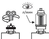
Необходимый расход теплоносителя устанавливается поворотом регулировочного штока против часовой стрелки. Фактическая величина расхода теплоносителя контролируется по показаниям расходомера.
