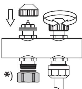
Для перекрытия контура достаточно закрыть термостатический вентиль: надеть и закрыть вращением по часовой стрелке защитные колпачки.
