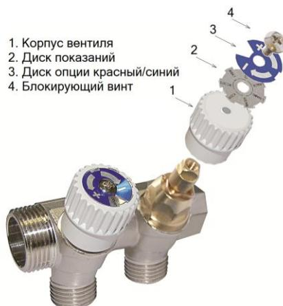
Крепление ручки из АБС-пластика производится винтом (4), который одновременно крепит два вращающихся алюминиевых диска (2, 3). На верхнем диске (3) указано направление вращения ручки. Нижний диск позволяет установить пользователю наименование обслуживаемого прибора.
