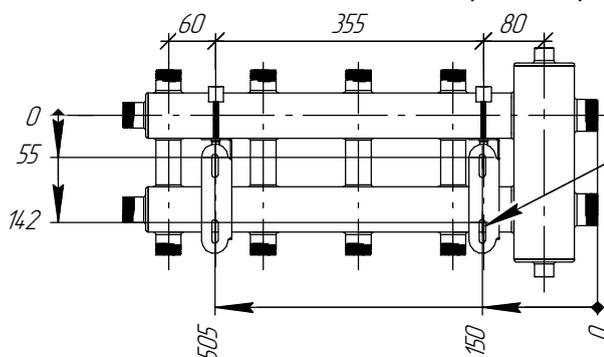
Монтажные пазы для регулировки высоты и горизонтального положения
