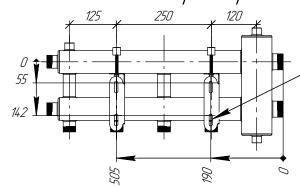
Монтажные пазы для регулировки высоты и горизонтального положения
