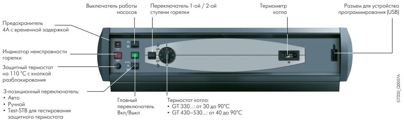
**Примечание:** все параметры настроек и измерений каждого из ведомых котлов с панелью КЗ доступны с панели управления Diematic-m 3 ведущего котла.
