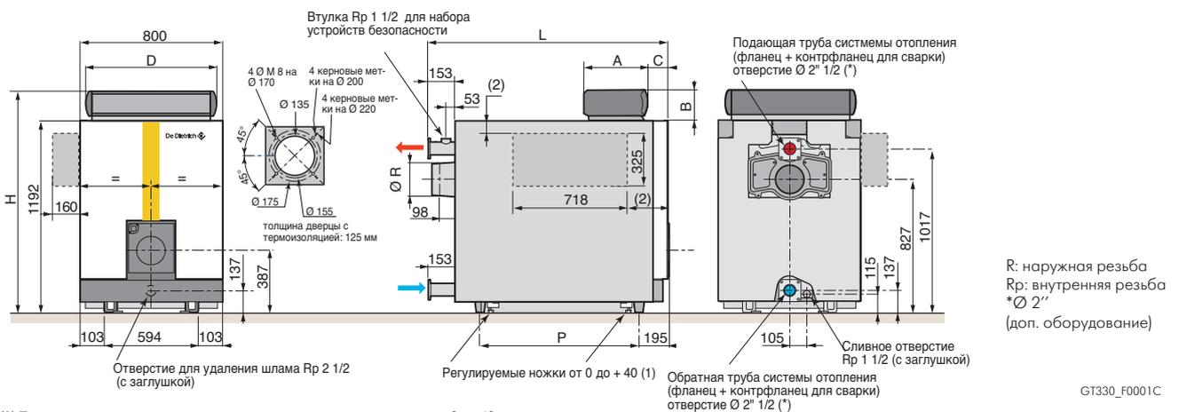
(1) При использовании «регулируемых ножек» весь котел поднимается от 0 до 40 мм.
