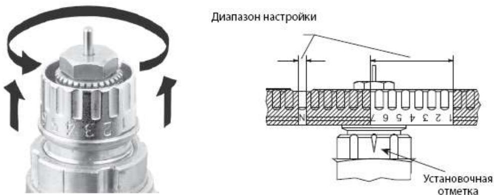
Рис.5 Схема предварительной настройки
