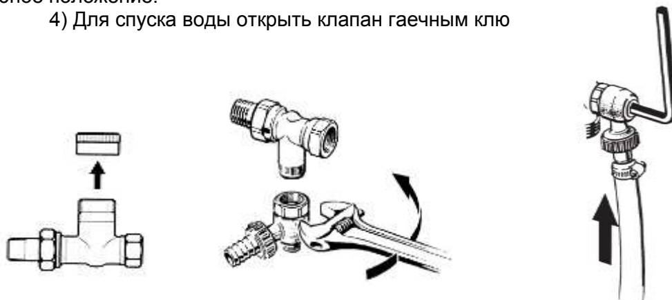
Рис. 3. Монтаж спускного крана.
