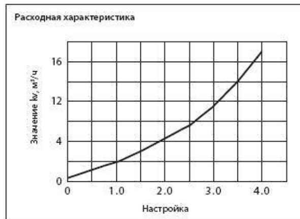
Диаграмма для подбора настройки клапана типа MSV-BD Ду = 32 мм
