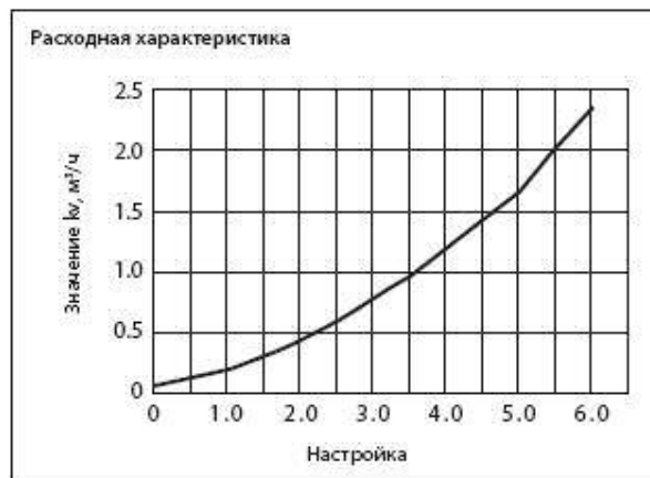
Диаграмма для подбора настройки клапана типа MSV-BD Ду = 15 мм LF версия
