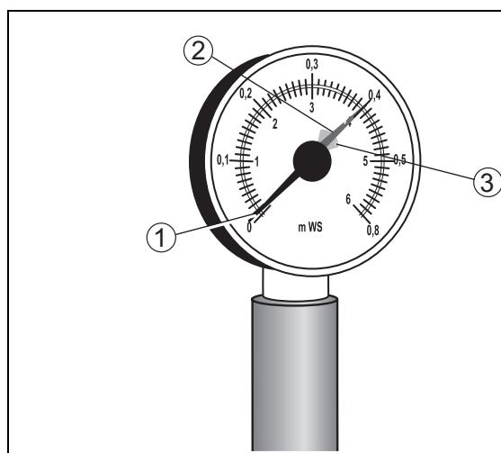
Рис. 33 Гидрометр для открытых отопительных установок
