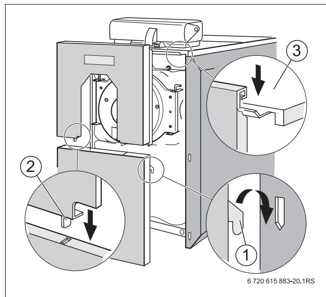
Рис. 24 Установка передней стенки SB315 Gas
