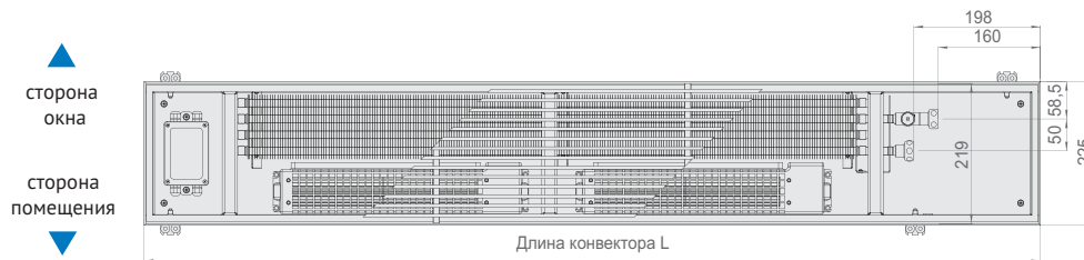
Вид сверху конвектора Qtherm ECO 225 с линейной решеткой, с U-образным бортом.
