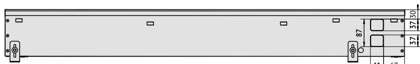
Вид сбоку конвектора Qtherm 300.150 с U-образным бортом.
