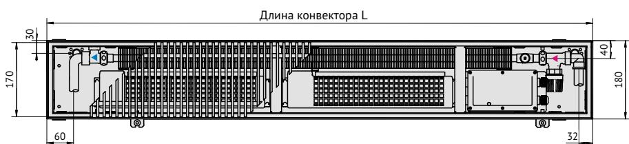
Вид сверху конвектора Qtherm 180 с роликовой решёткой, с U-образным бортом, с дренажом.
