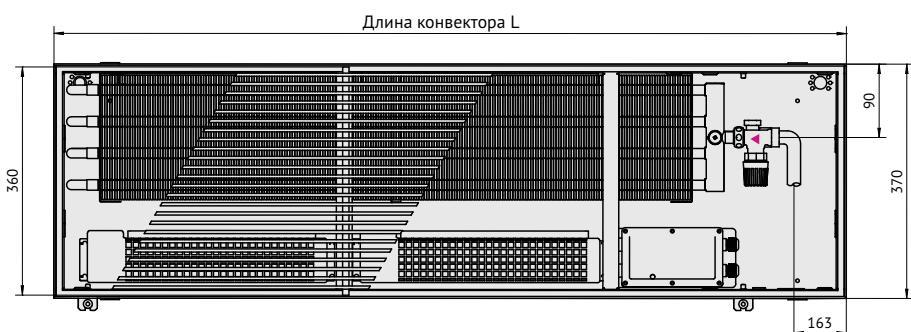
Вид сверху конвектора Qtherm 370 с роликовой решёткой, с U-образным бортом, с дренажом.
