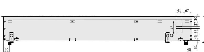
Вид сбоку конвектора Qtherm 370.150 с U-образным бортом, с дренажом.
