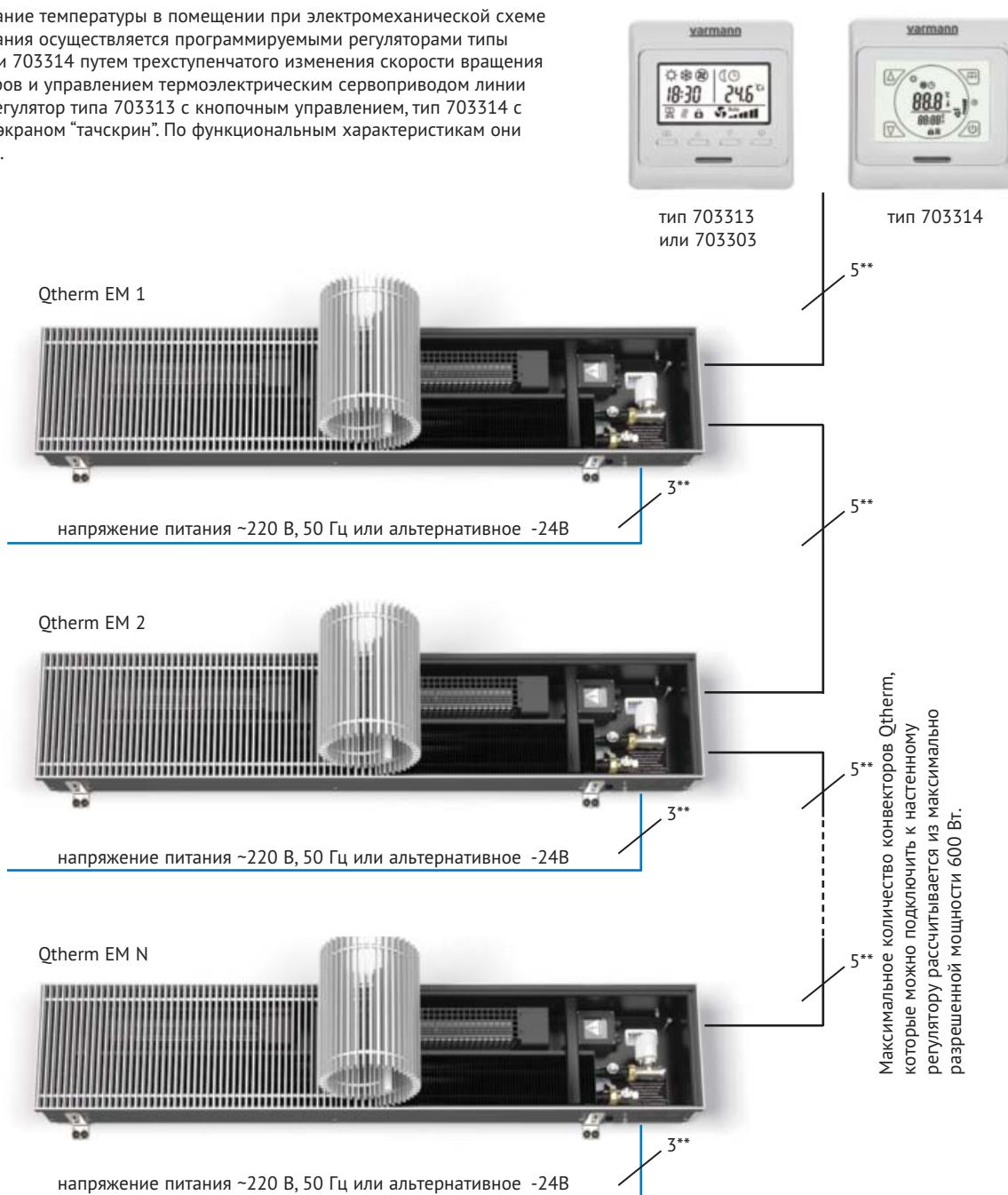
\*\* Сечение кабеля рассчитывается от потребляемой мощности конвекторов. Рекомендуется кабель типа NYM с мин. сечением 1,5 мм<sup>2</sup>.
