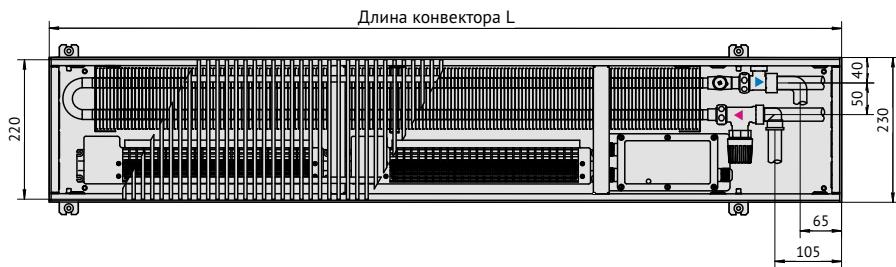
Вид сверху конвектора Qtherm 230 с роликовой решеткой, с U-образным бортом.
