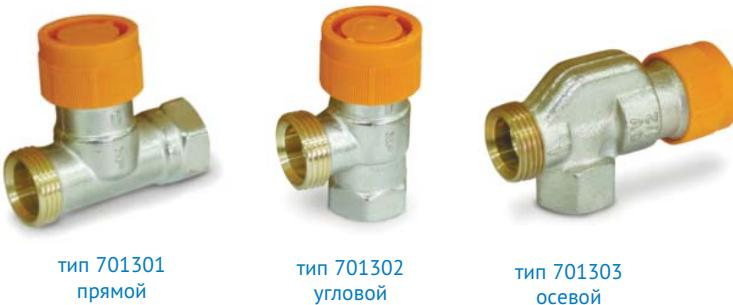
Вентили на подающую линию DN15, G 3/4", с защитным колпачком, в латунном корпусе, с нержавеющим стальным шпинделем и двойным концевым уплотнением, для двухтрубных систем отопления,  $k_{VS}=1.35$ , для однотрубных систем отопления,  $k_{VS}=1.8$ . Используются для конвекторов с подключением "сбоку" без встроенного вентиля.
