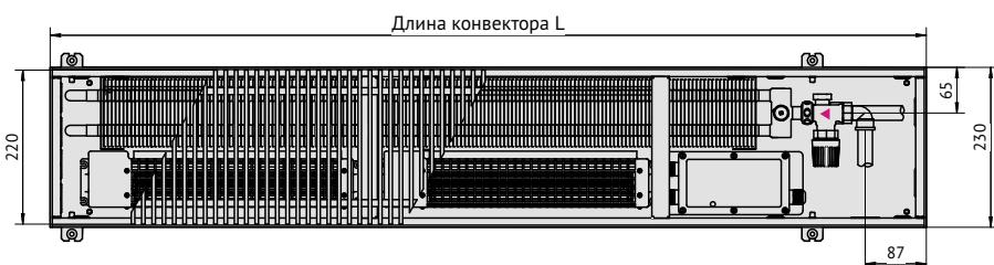
Вид сверху конвектора Qtherm 230.150 с роликовой решеткой, с F-образным бортом.
