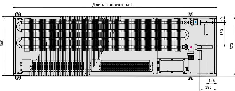
Вид сверху конвектора Qtherm 370 с роликовой решеткой, с U-образным бортом.
