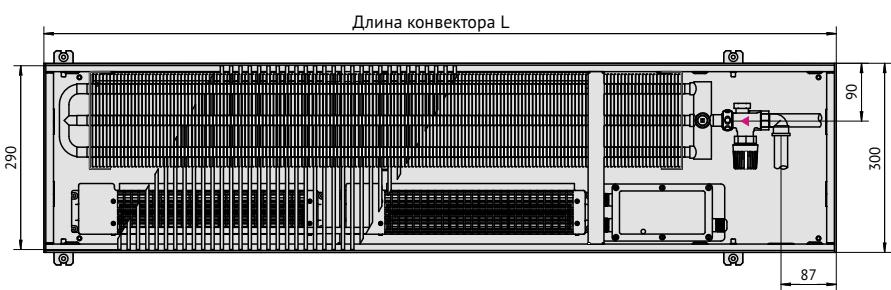
Вид сверху конвектора Qtherm 300.150 с роликовой решеткой, с F-образным бортом.
