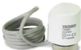
Термоэлектрический сервопривод для монтажа на терmostатический вентиль конвектора, резьбовое соединение M 30 x 1.5. Подключается к настенному регулятору тип 703402, 703403 или к встроенному блоку регулирования. Имеет индикатор вкл/выкл.
