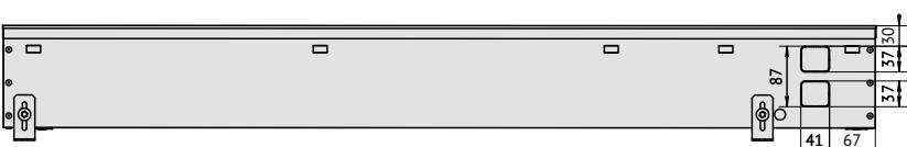
Вид сбоку конвектора Qtherm 370.150 с U-образным бортом.
