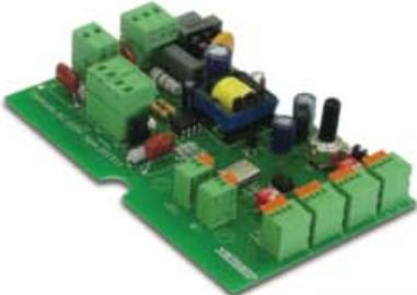
**Блок микропроцессорного регулятора тип 201112, напряжение питания 24В,**
