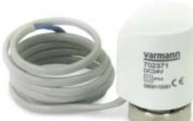
Термоэлектрический сервопривод для монтажа на терmostатический вентиль конвектора, резьбовое соединение M 30 x 1.5. Предназначен для комплектации конвекторов с напряжением питания вентиляторов -24В. Подключается к встроенному блоку регулирования. Имеет индикатор вкл/выкл.
