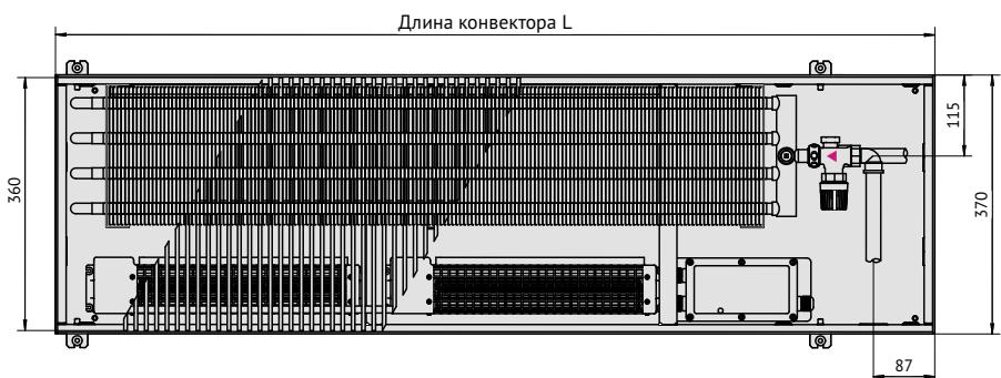
Вид сверху конвектора Qtherm 370.150 с роликовой решеткой, с F-образным бортом.
