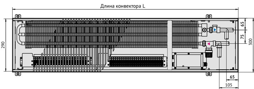
Вид сверху конвектора Qtherm 300 с роликовой решеткой, с U-образным бортом.
