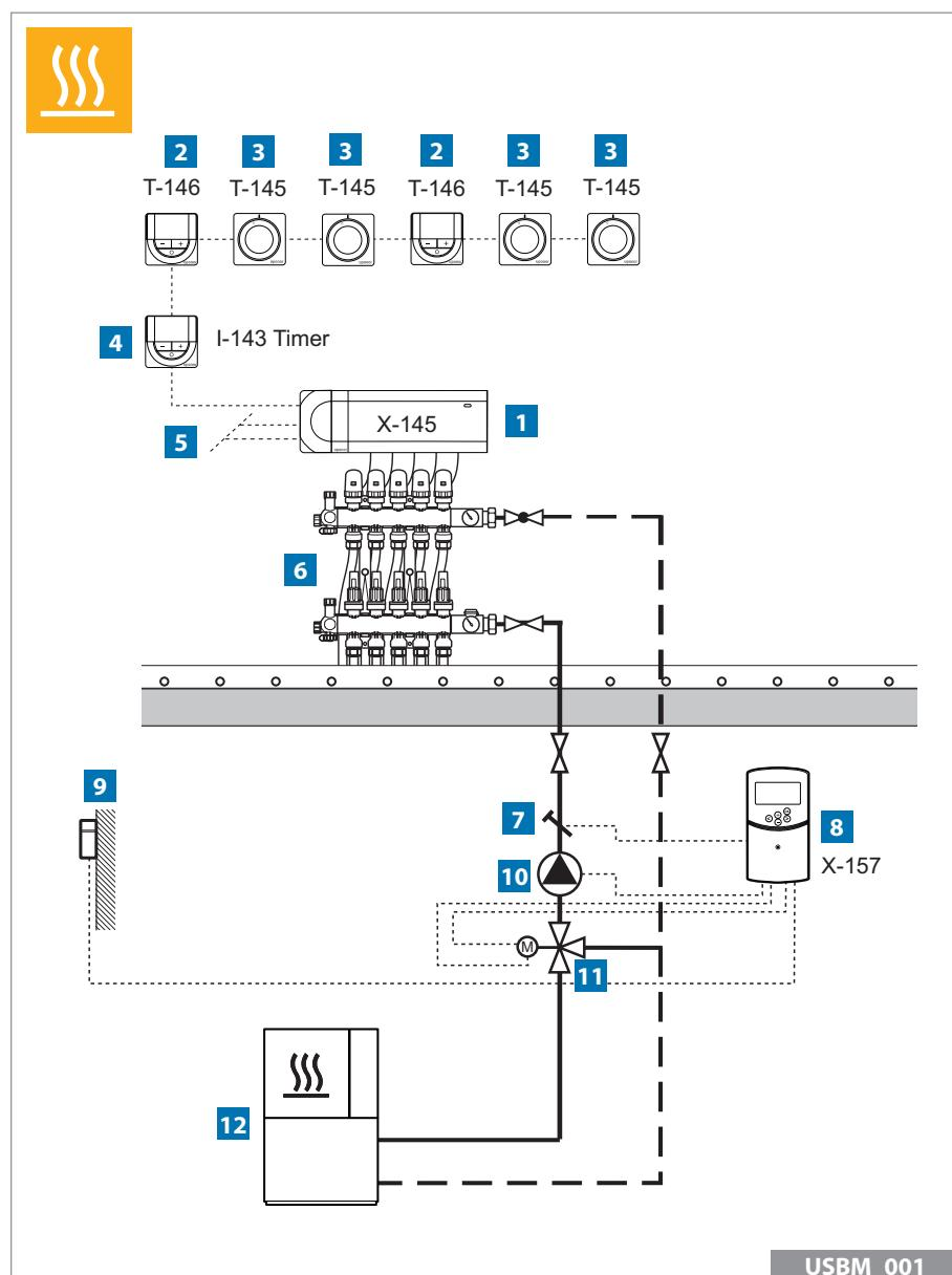
На схеме представлено упрощенное изображение основных компонентов управления системой отопления; при этом осуществляется контроль как температуры в помещениях, так и температуры теплоносителя на подаче. Для подсоединения термостатов к комнатному контроллеру X-145 используется последовательная схема подключения (топология шина). На странице 38 приведены рекомендуемые характеристики кабеля.
