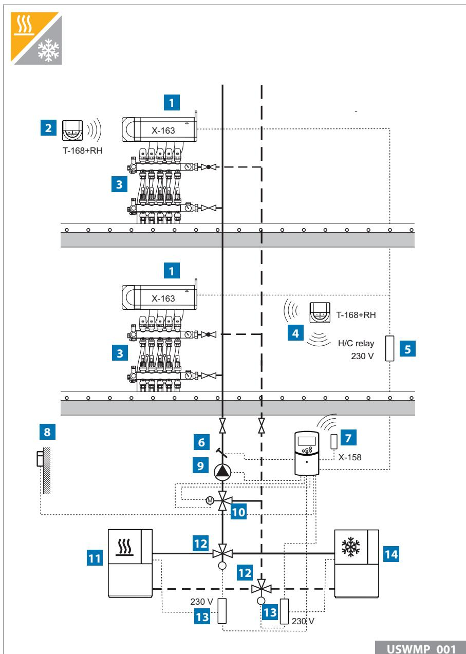
На схеме представлено упрощенное изображение основных компонентов управления системой отопления и охлаждения; при этом осуществляется контроль как температуры в помещениях, так и температуры теплоносителя/хладоносителя на подаче. Контроллер температуры подачи X-158 по проводной связи может посыпать сигнал переключения режимов «отопление/охлаждение» как на контроллеры X-163, так и на источник отопления/охлаждения.
