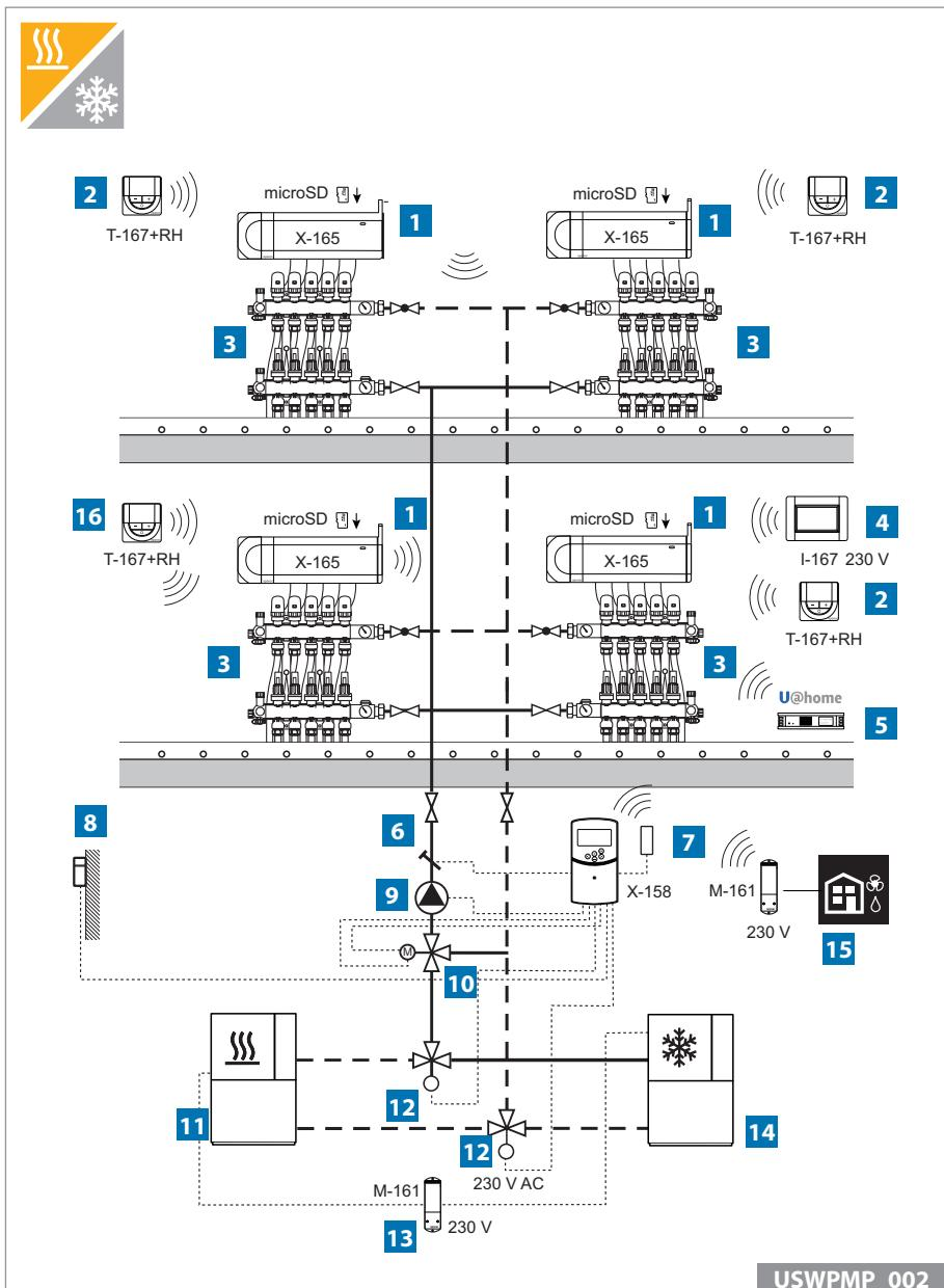
На схеме представлено упрощенное изображение основных компонентов управления системой отопления и охлаждения; при этом осуществляется контроль как температуры в помещениях, так и температуры теплоносителя/хладоносителя на подаче. Переключение между режимами отопления и охлаждения, а также управление осушением осуществляется с помощью релейных модулей M-161. В одной системе с использованием панели управления I-167 и модуля U@home R-167 может быть объединено до четырех контроллеров X-165.
