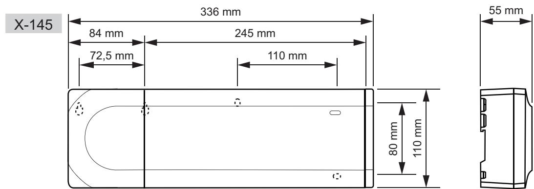
**Размеры контроллера с дополнительным модулем, трансформатором и торцевой крышкой**
