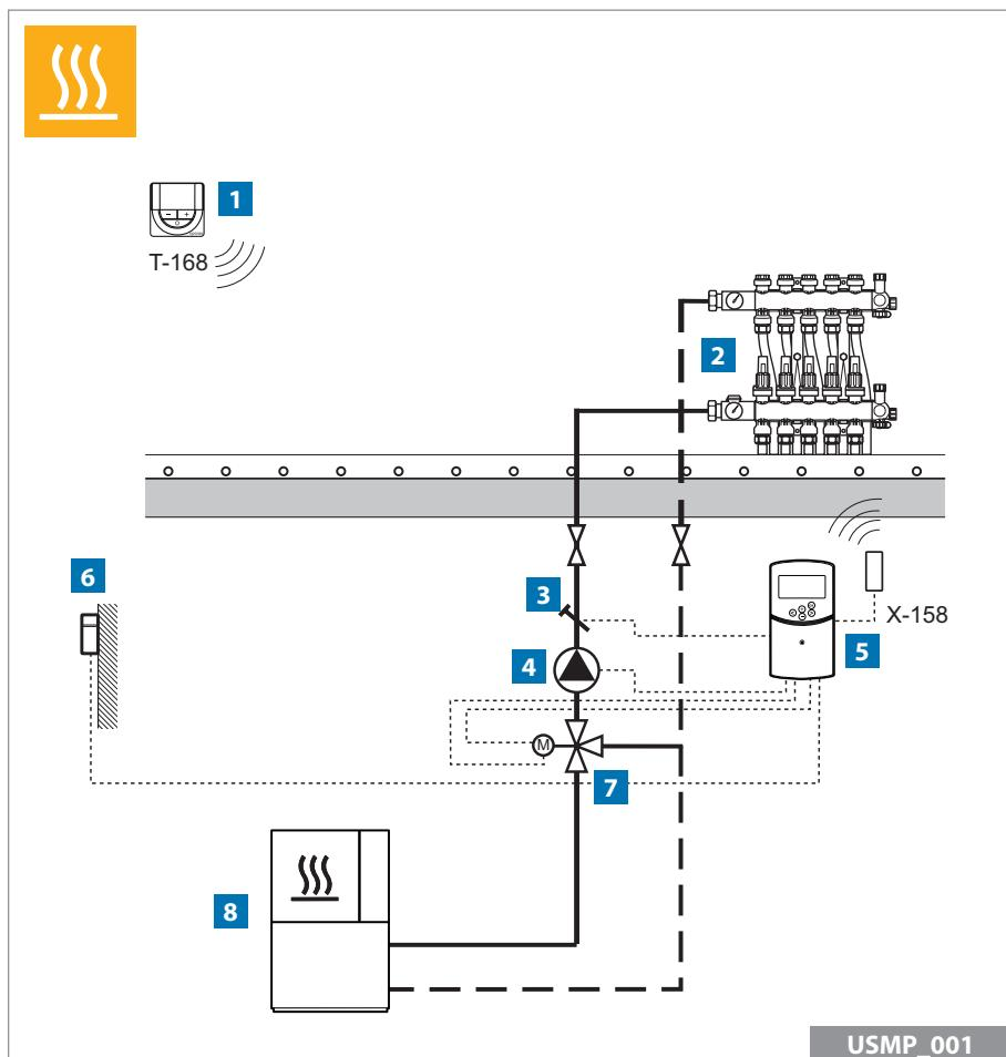
На схеме представлено упрощенное изображение главных компонентов управления, которые применяются при контроле температуры в помещении, а также при контроле температуры подаваемой воды для одной зоны. Термостат T-168 зарегистрирован в контроллере подаваемой воды X-158, который регулирует температуру подаваемой воды для поддержания заданной температуры воздуха.
