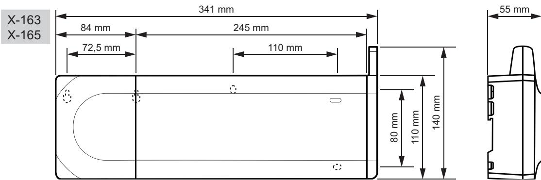
**Размеры контроллера с дополнительным модулем, трансформатором и антенной**
