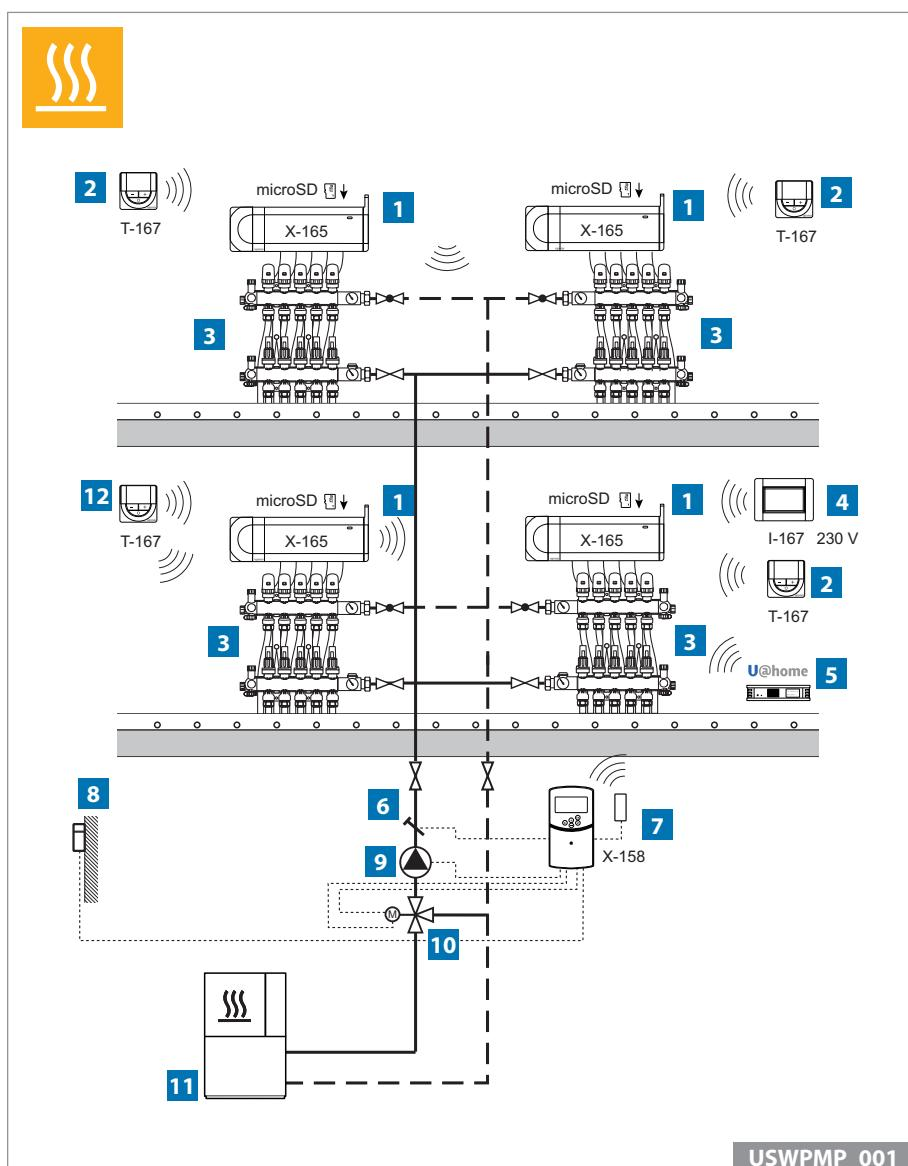
На схеме представлено упрощенное изображение основных компонентов управления системой отопления; при этом осуществляется контроль как температуры в помещениях, так и температуры теплоносителя на подаче. В одной системе с использованием панели управления I-167 и модуля U@home R-167 может быть объединено до четырёх контроллеров X-165.
