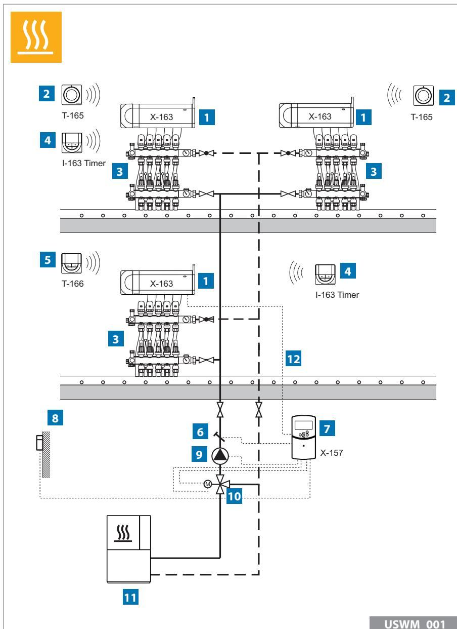
На схеме представлено упрощенное изображение основных компонентов управления системой отопления; при этом осуществляется контроль как температуры в помещениях, так и температуры теплоносителя на подаче. Контроллер X-163 через проводную связь может подавать сигнал на контроллер Smatrix Move для включения насоса.
