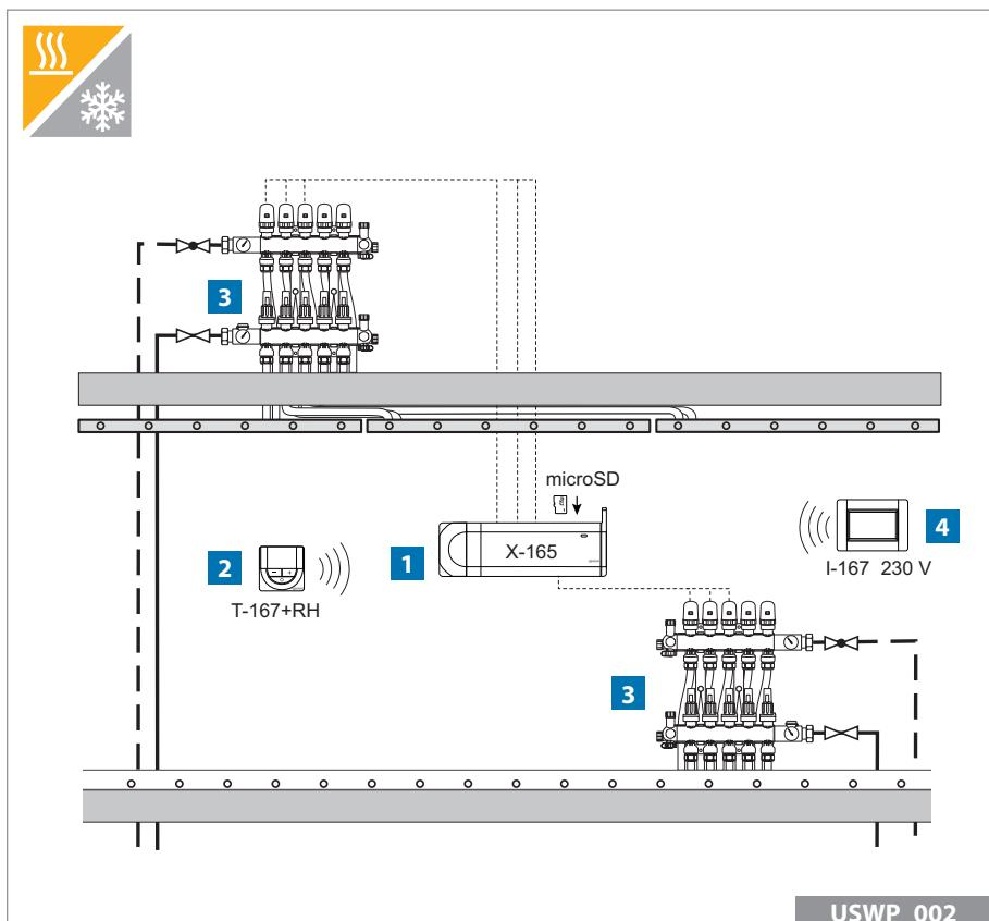
На схеме представлено упрощенное изображение главных компонентов управления, которые применяются при сочетании систем напольного отопления и потолочного охлаждения; при этом осуществляется контроль температуры в помещении. Для управления напольным отоплением и потолочным охлаждением служат контроллер X-165 и термостат T-167. Переключение режимов отопления и охлаждения можно осуществить либо с помощью панели управления I-167, либо с помощью термостата T-167.
