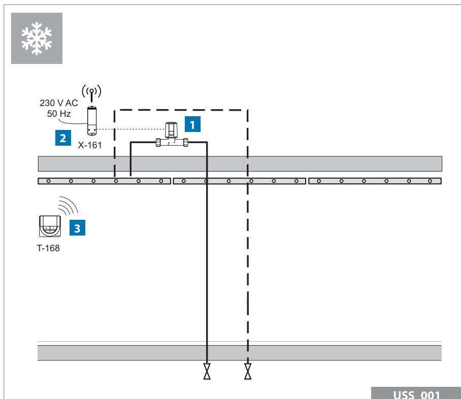
На схеме представлено упрощенное изображение главных компонентов управления для потолочного охлаждения, управляемого системой охлаждения Smatrix Space PLUS.
