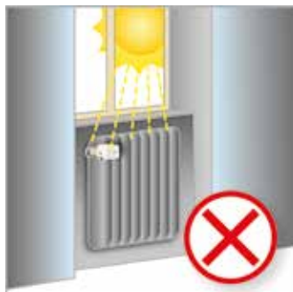
Рис. 7.10. Требования по размещению автоматического терморегулятора
