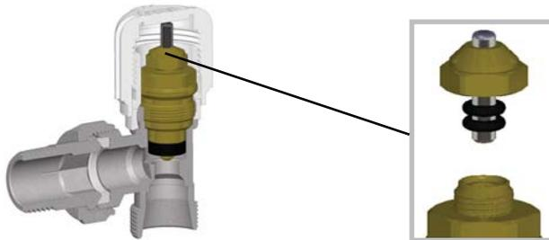
Possibilità di sostituire gli o-rings di tenuta del vitone della valvola senza svuotare l'impianto.
